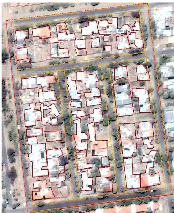
Figura 2-8. Determinación de áreas impermeables (ejemplo)
