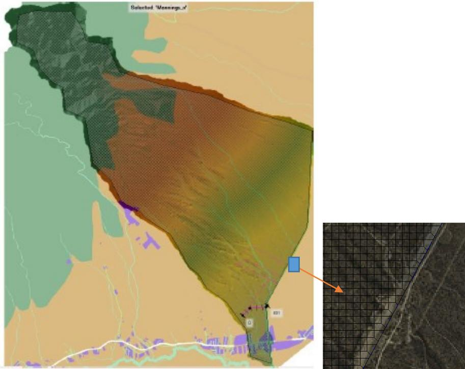
Figura 2-16. Grilla del modelo geométrico y Coef. de Manning (ejemplo para Cuenca 8). Elaboración propia.
