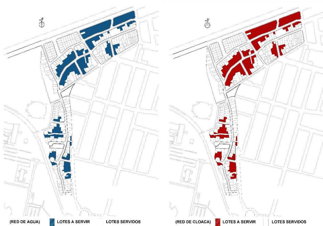
Imagen 12: plano servicios de agua y cloaca. Fuente: elaboración propia, 2019.
