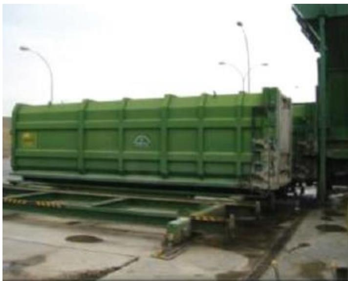
Figura 28: Foto ilustrativa del sistema de traslación de contenedores
