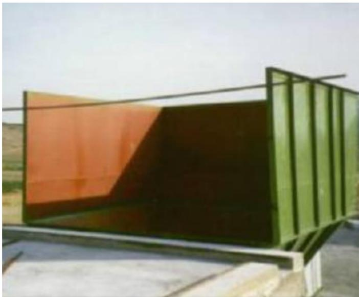
Figura 27: Imagen ilustrativa de Tolva descargando en compactador estático
