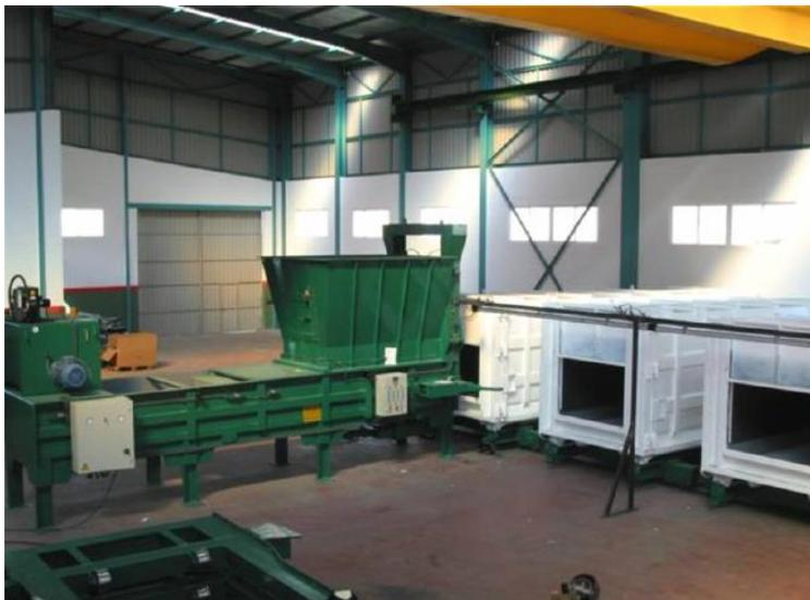
Figura 29: Imagen Ilustrativa de Compactador Estático
