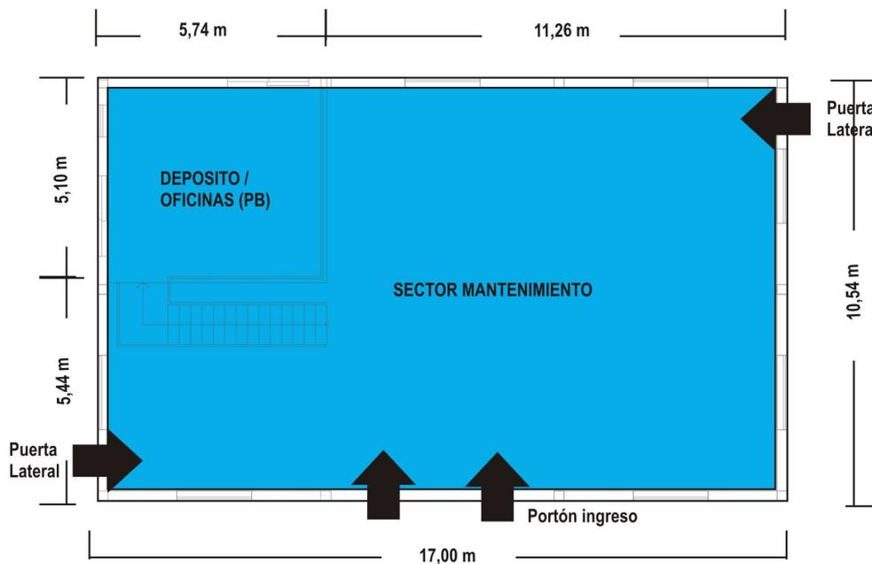
Figura 3: Esquema Galpón de Mantenimiento
