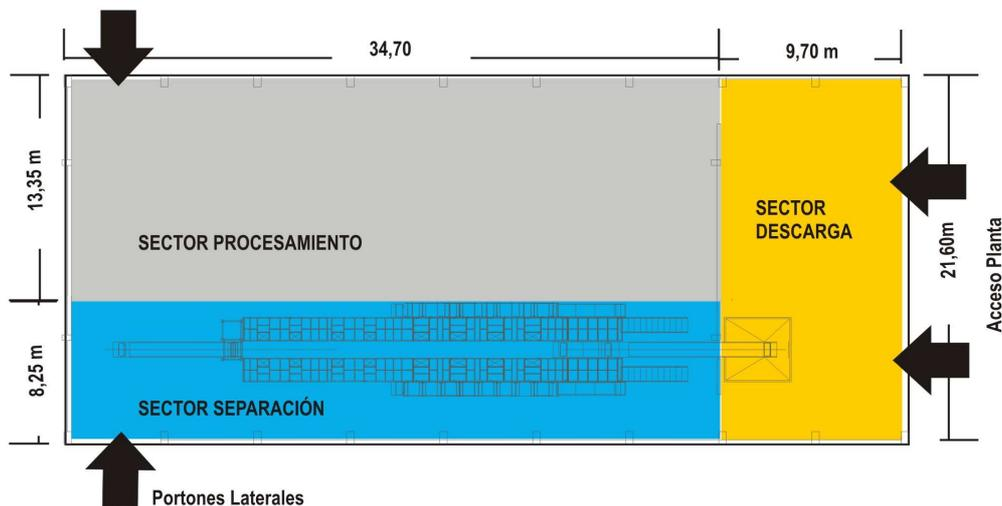
Figura 1: Esquema Planta de Separación
