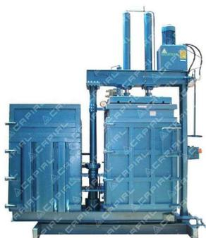
La enfardadora de doble cajón giratorio es la máquina encargada de compactar el material ya clasificado, proveniente de Pesaje (si el mismo ha sido separado en origen) o de Cinta. Consta de dos cilindros hidráulicos que presan el material en forma vertical y de manera uniforme cargado desde
