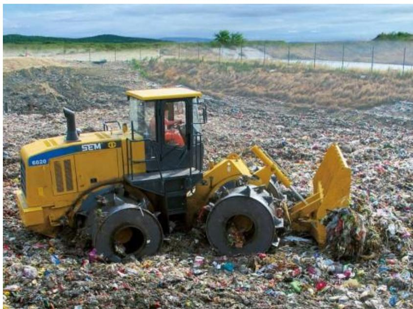
Figura 27: Compactador con ruedas metálicas
