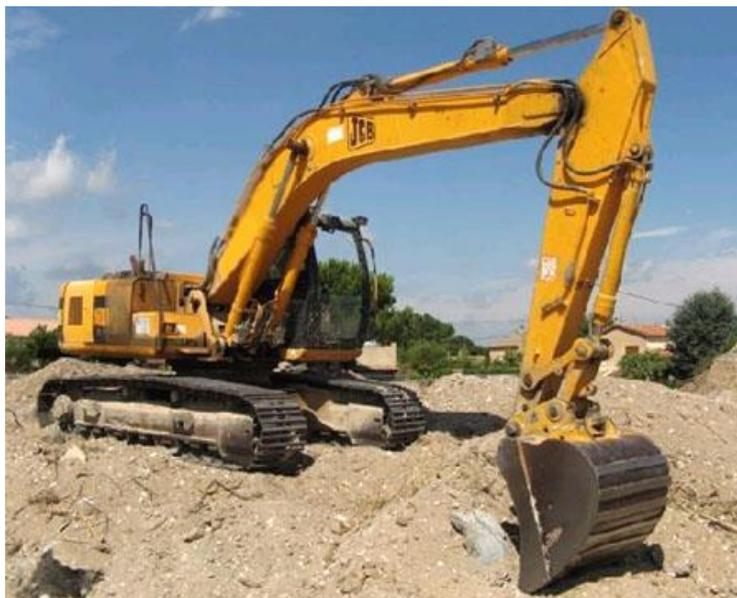
Figura 30: Retroexcavadora sobre orugas
