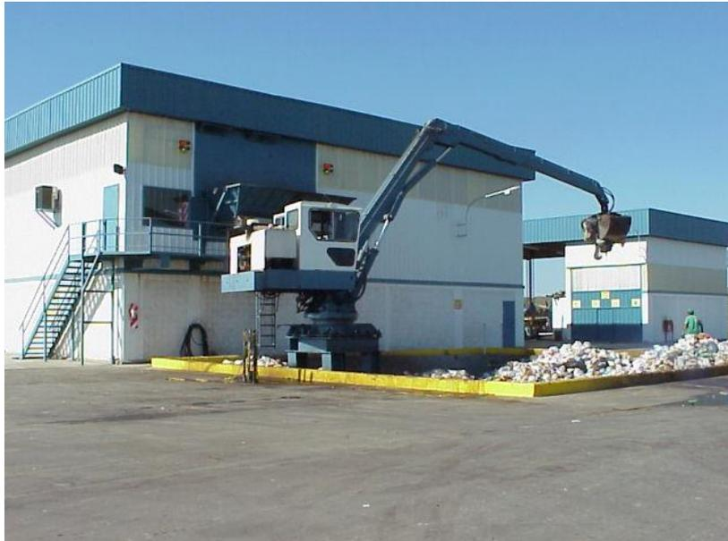
**Figura 97: Brazo Hidráulico para carga de residuos**
