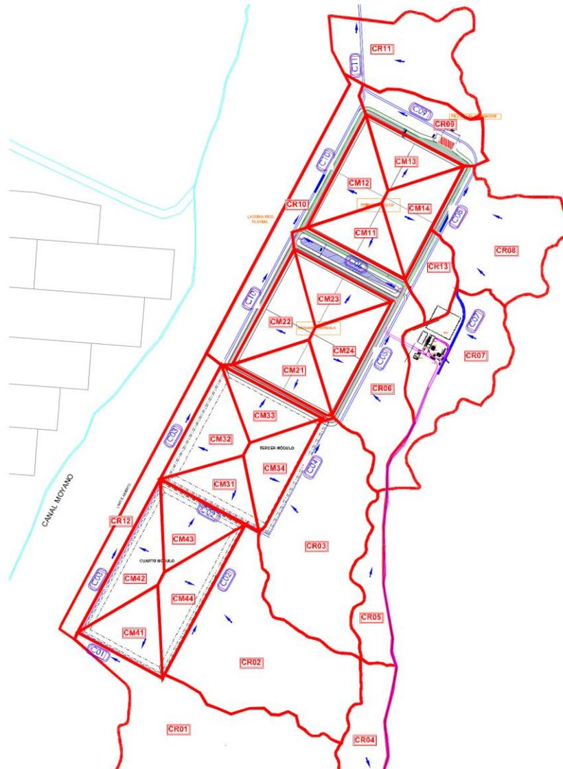
Figura 20: Esquema Hidráulico del Centro Ambiental y Cuencas internas del predio
