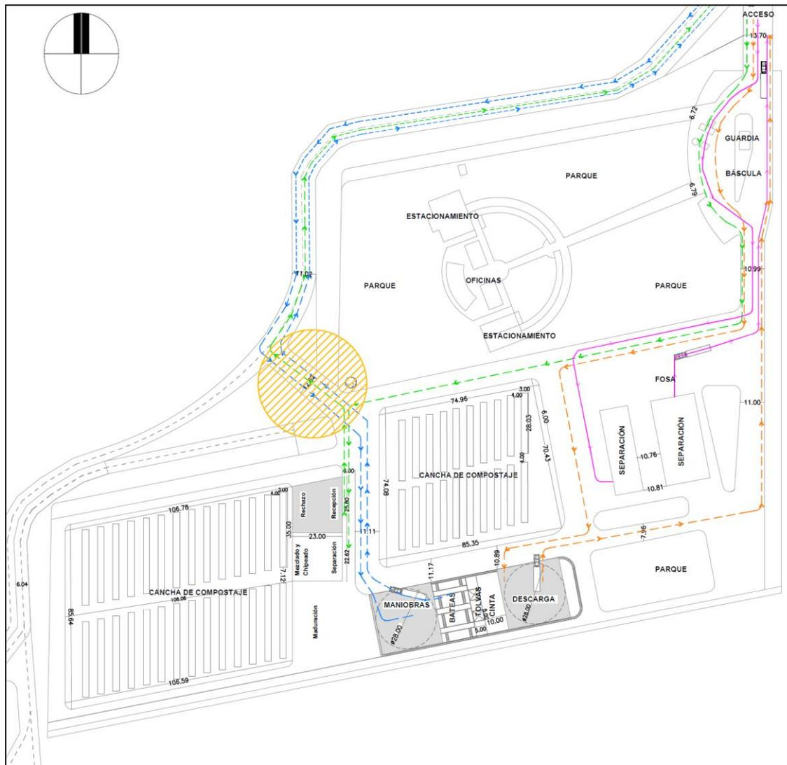
**Figura 32: Circulación Interna Planta de Maipú**
