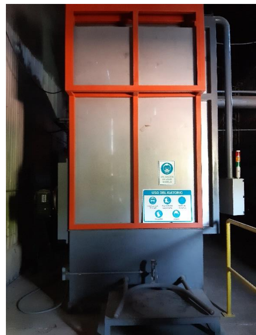
Fig.9 – Dispositivo de Apertura Segura de Tambores. Fuente: Comisión Auditora FCAI
