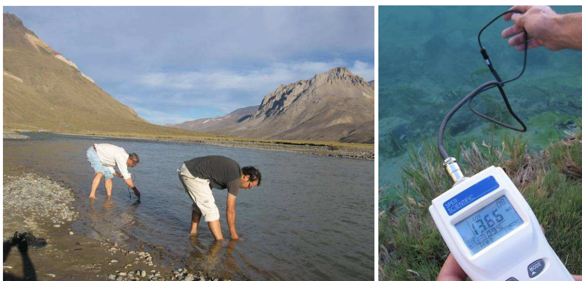
Figura 3. Toma de muestras y medición de la conductividad eléctrica de agua superficial
