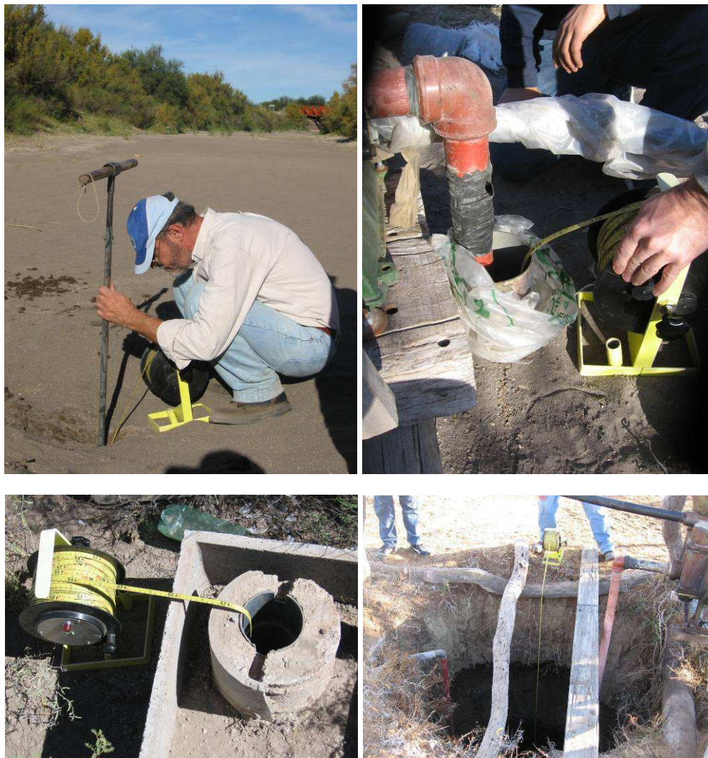
Figura 2. Tareas de barrenado manual y medición de pozos (puestos Anguero Ugalde y El Paramillo, Abril de 2011)
