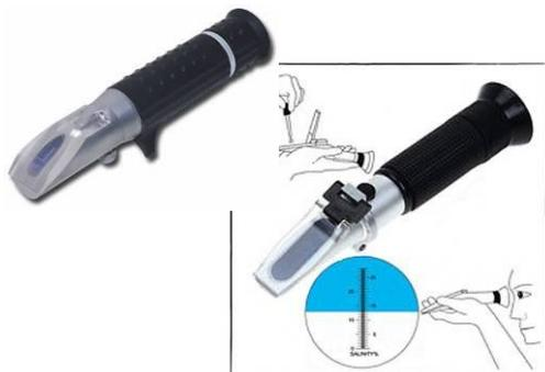
Refractómetros de bolsillo, de escala simple o doble.
