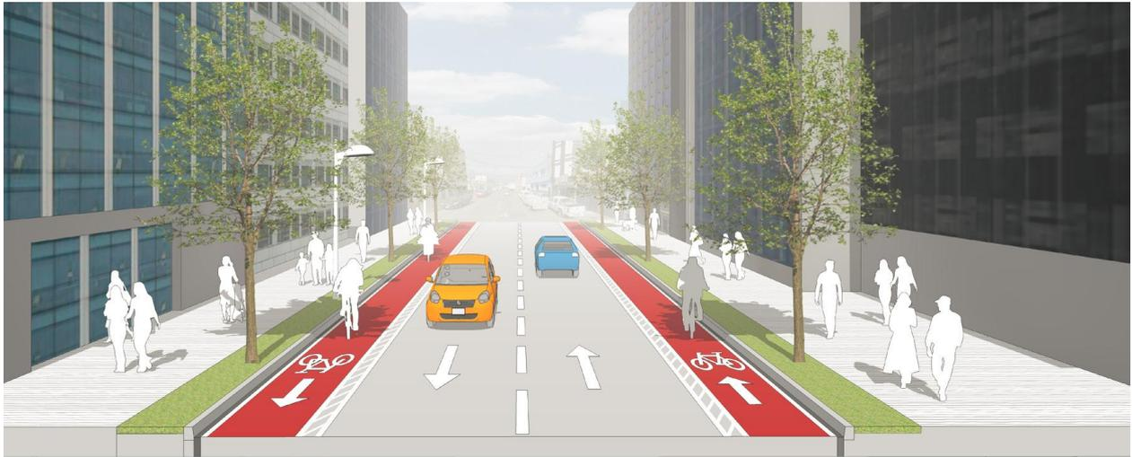
Imagen 3. Ciclocarril Fuente: Manual de Criterios de Diseño de Infraestructura Ciclo-inclusiva y Guía de Circulación del Ciclista, 2017
