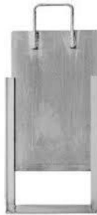
**Figura 1: Compuerta de riego: marco y compuerta plana**
