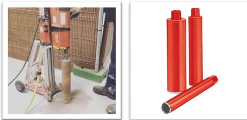
Figura 10. Fotos de m1quina (sacatestigo) que se va a usar en el proyecto y sus copas diamantadas
