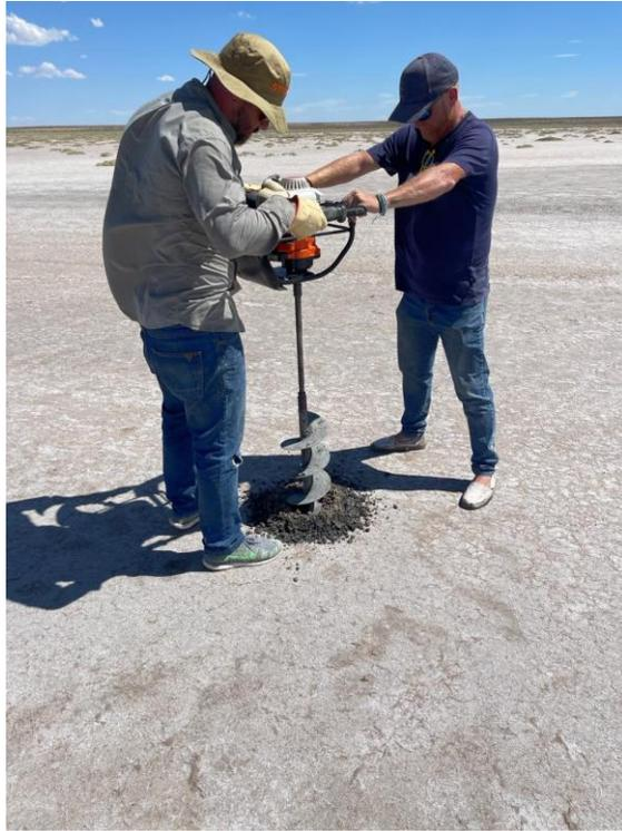
Perforación con hoyadora para extracción de muestra.
