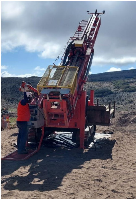
Fotografía 20.7 Vista de una máquina perforadora para perforación con método Diamantina (DDH)
