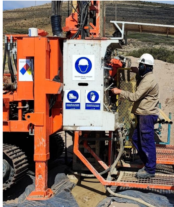
Fotografía 20.8 Vista de una máquina perforadora para perforación con método Diamantina (DDH)
