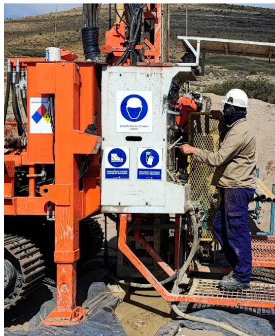
Fotografía 20.8 Vista de una máquina perforadora para perforación con método Diamantina (DDH)
