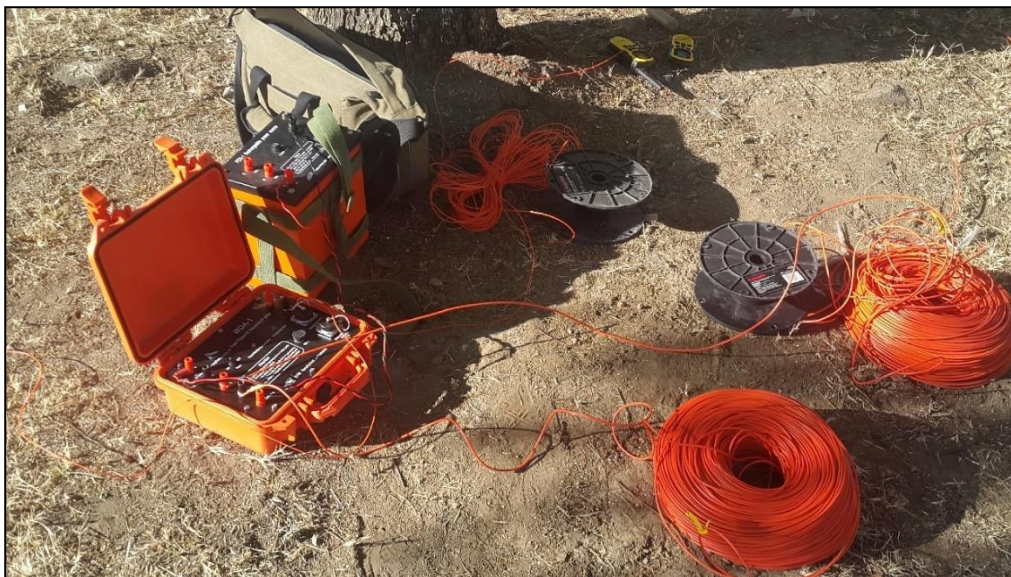
Fotografía 20.1 Vista de los elementos de un sistema geoelectrico.
