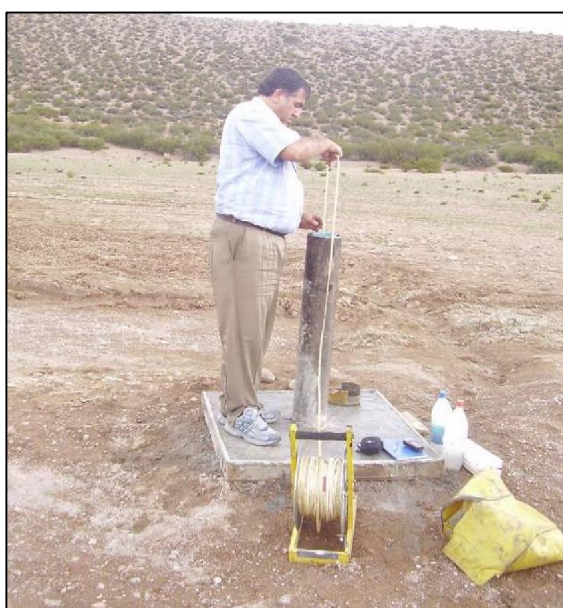
Fotos 2 y 3: detalle de las tareas de perforación correspondientes al pozo SJ_PM_1. La imagen de la izquierda corresponde a mediciones del nivel de agua en boca de pozo, registrándose un acuífero colgado a los 20 metros y el acuífero freático a los 50,68 m. La fotografía de la derecha muestra en detalle el caño de protección de superficie, de una longitud de 1.05 m y diámetro de 6 ½", con el soporte para asegurar la tapa. En su interior se observa la cañería PVC de 4".
