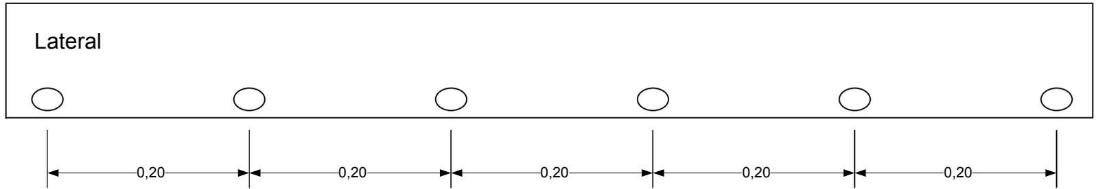
**Tubería Perforada PVC 110 mm**
