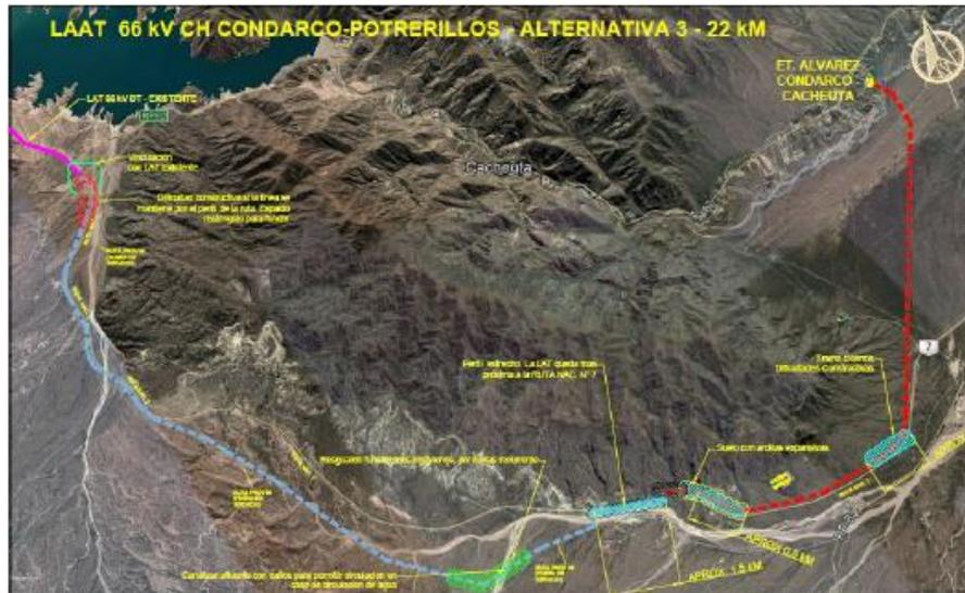
**Ilustración 5-3. Alternativa 3, analizada para la traza de la LAAT 66kV ST**
