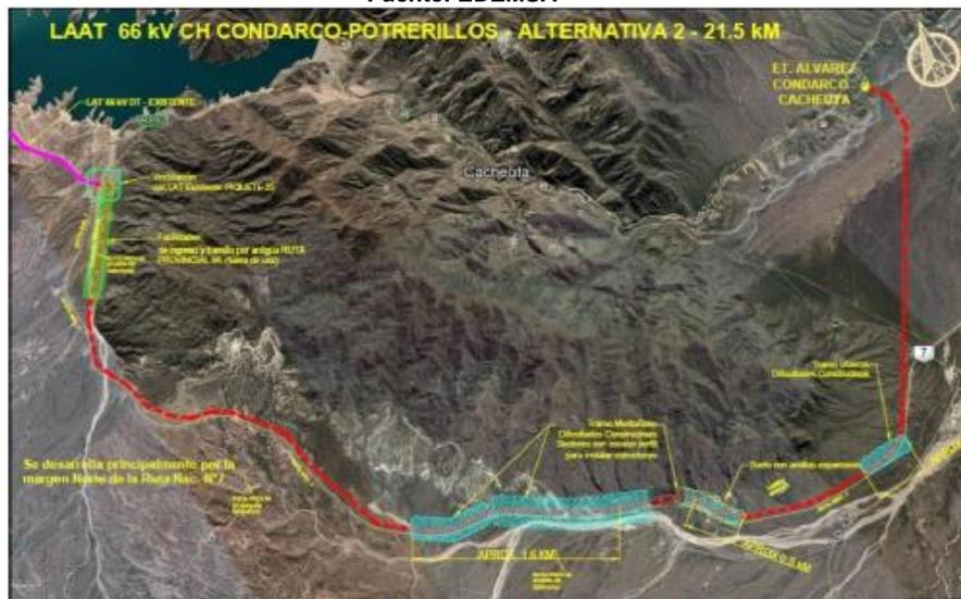
**Ilustración 5-2. Alternativa 2, analizada para la traza de la LAAT 66kV ST**
