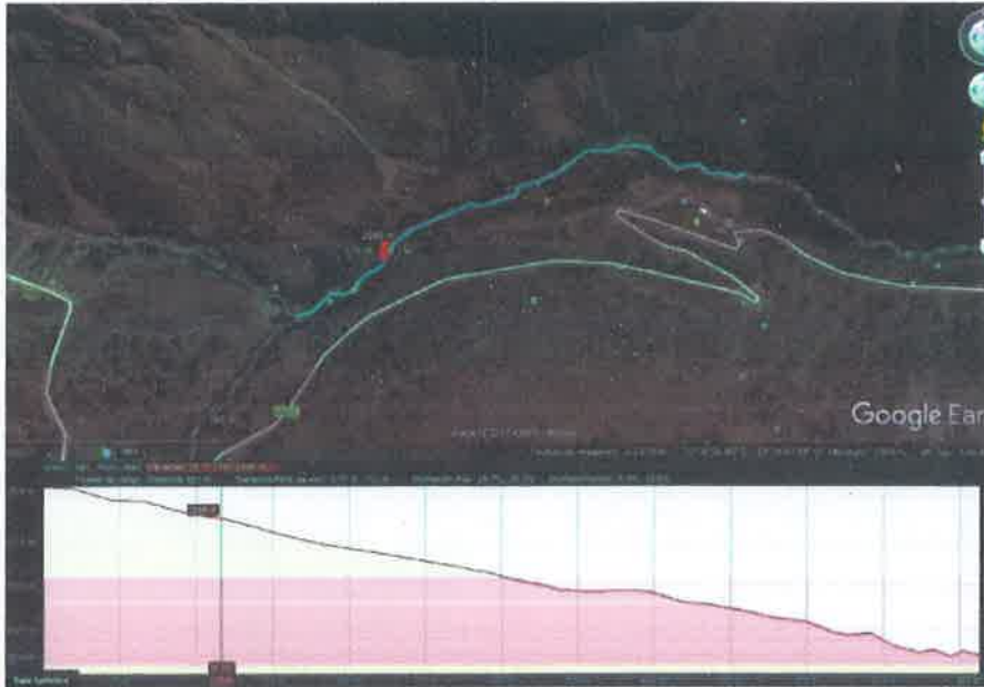
Figura 2: Perfil de elevación del tramo del Arroyo Grande aguas abajo de la toma parrilla (flecha roja)
