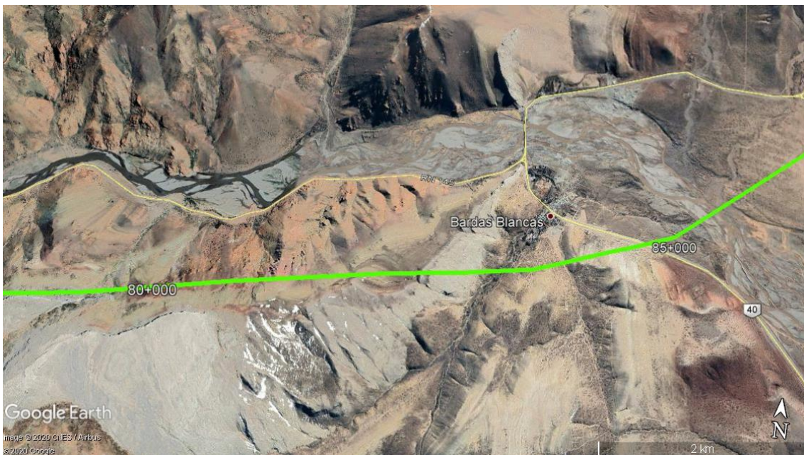
Figura 157. Traza de la línea de Interconexión 500Kv Nueva EETT Los Cóndores (Chile), ampliación EETT Río Diamante” (San Rafael-Argentina), sector Bardas Blancas (Malargüe).
