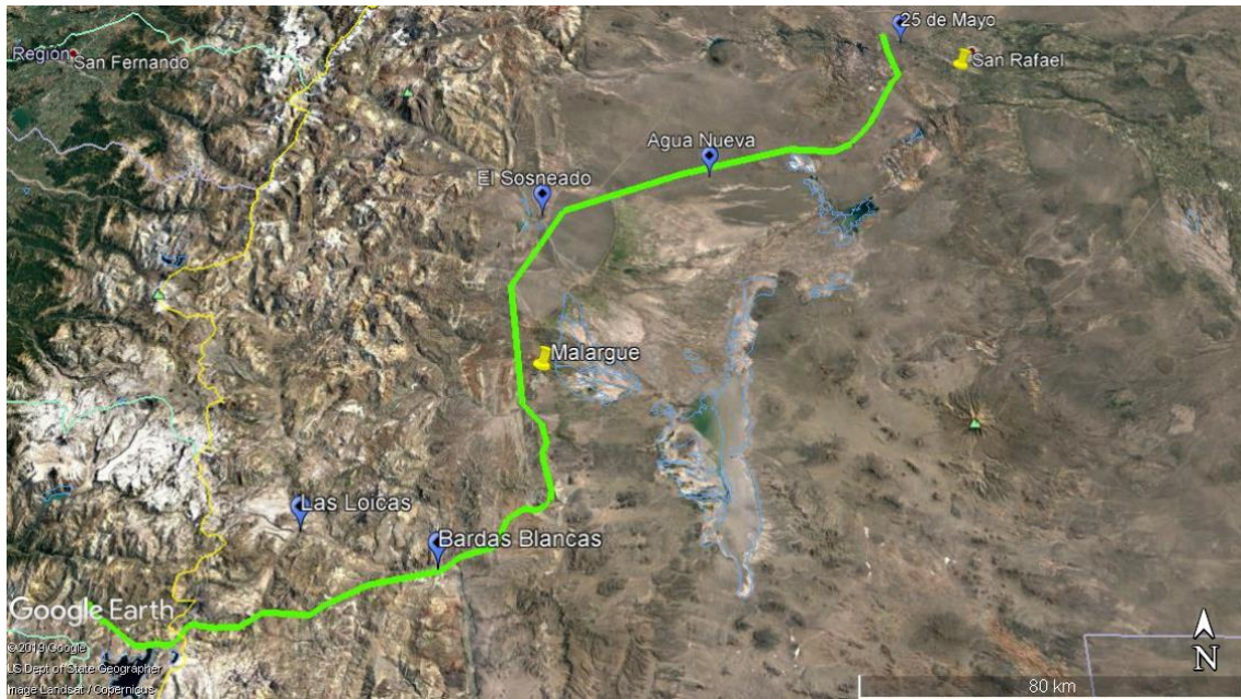
Figura 106. Traza propuesta para la construcción de la línea de interconexión 500Kv entre Los Cóndores (Chile) y Río Diamante (San Rafael - Mendoza, Argentina).
