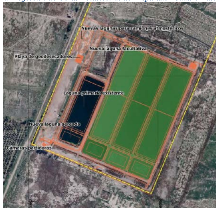
Figura 2. Proyección de Obras Establecimiento Depurador Cuadro Nacional.
