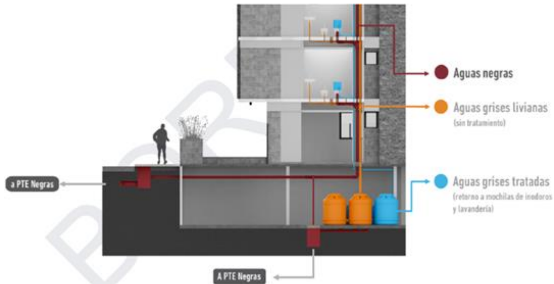
Figura 32. Esquema de cañerías separadas para aguas grises in situ, proyectado para grandes unidades habitacionales.
