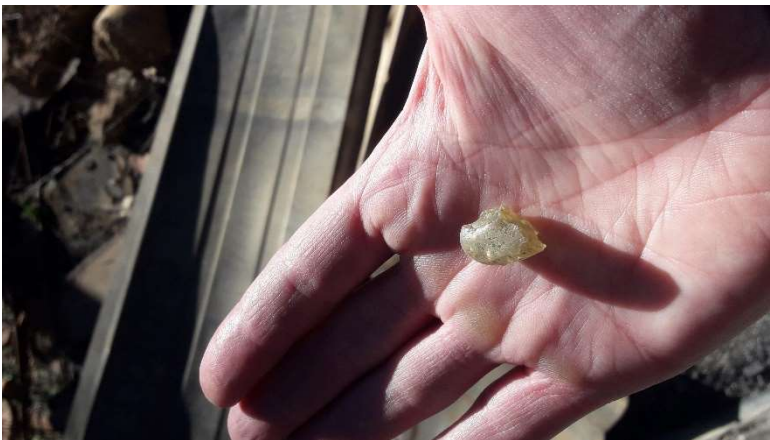
Trozo de vidrio fundido. Nos da una idea de las altas temperaturas alcanzadas.
