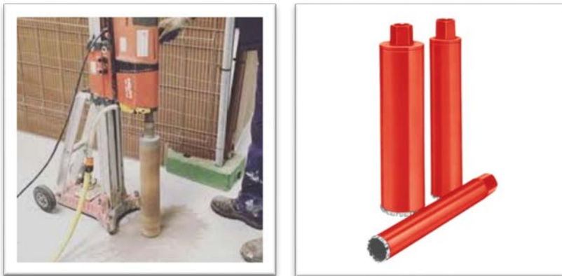
Figura 10. Fotos de máquina (sacatestigo) que se va a usar en el proyecto y sus copas diamantadas
