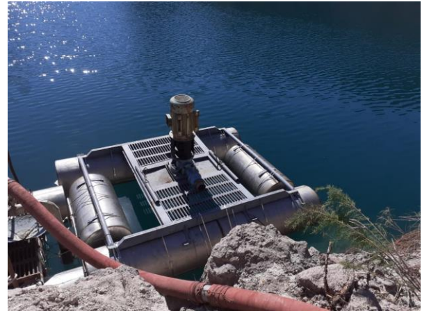
Fig. 1 y 2 – Instalación de la bomba utilizada para el trasvase desde la Cantera Tigre III a Dique DN 8-9
