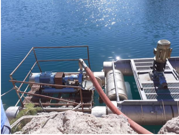
Fig. 1 y 2 – Instalación de la bomba utilizada para el trasvase desde la Cantera Tigre III a Dique DN 8-9
