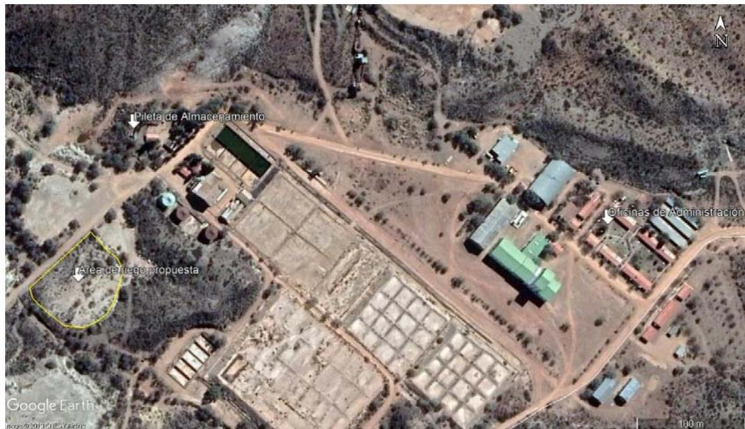
El área de reuso se encuentra ubicada en las cercanías de la pileta de almacenamiento lo que minimiza el riesgo de ruptura en la cañería de conducción y además está ubicada a favor de la dirección y sentido de los vientos con respecto al CMFSR. Por otra parte una menor distancia a la pileta reduce la inversión inicial y costos fijos de mantenimiento y conducción.
