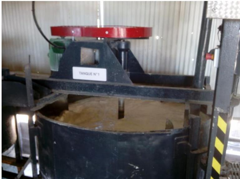
Foto Nº1.- Tanque Nº1 donde se produce el contacto de líquido con la lechada de cal
