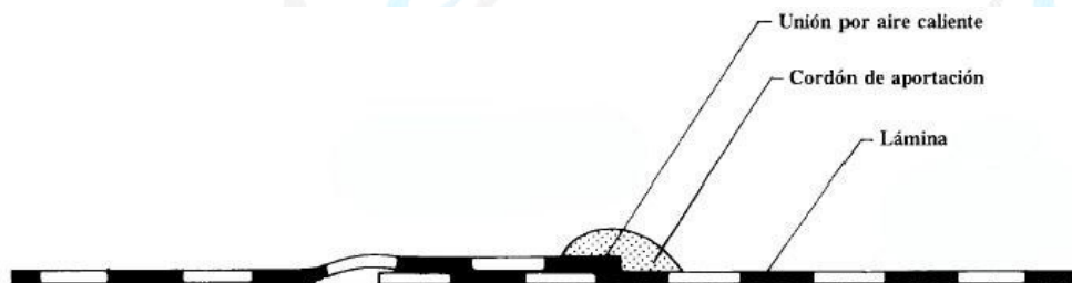
Figura 2. Soldadura por extrusión
