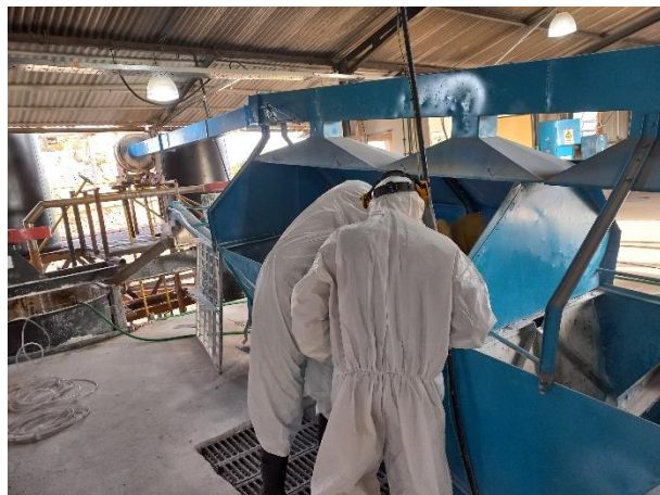
Fig. 5 – Carga de cal mediante tornillo sin fin.
