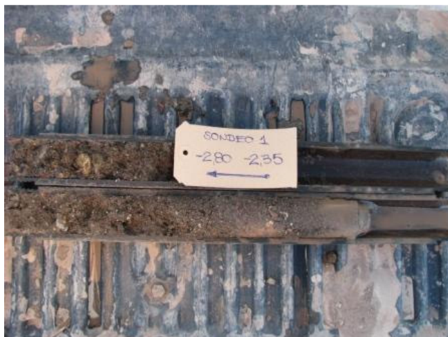
Sondeo N°1 – Muestra 3 – Profundidad -2.35 a -2.80m
