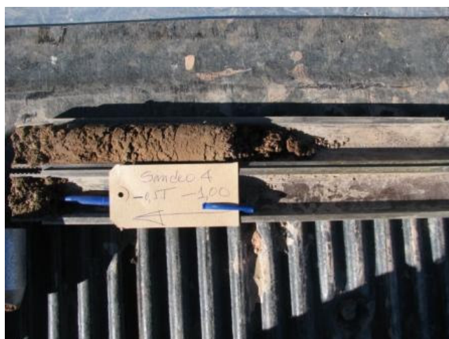
Sondeo N°4 – Muestra 1 – Profundidad -0.55 a -1.00m
