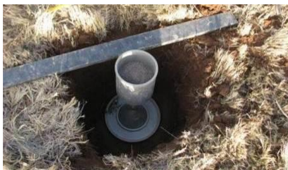
Sondeo N°5-1 – Método del Cono de Arena
