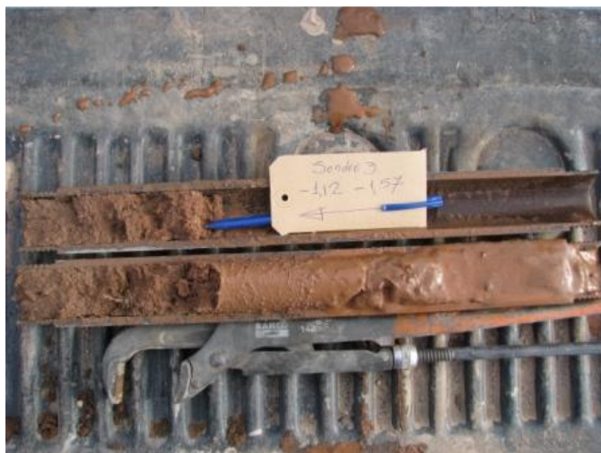
Sondeo N°3 – Muestra 2 – Profundidad -1.50 a -1.95m
