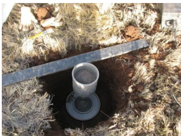
Sondeo N°5 – Método del Cono de Arena
