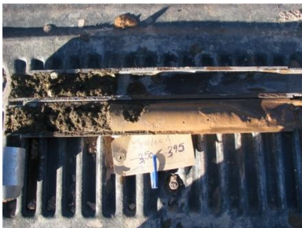
Sondeo N°4 – Muestra 4 – Profundidad -3.50 a -3.95m
