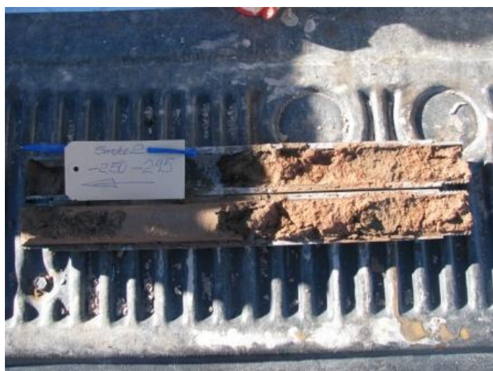
Sondeo N°2 – Muestra 3 – Profundidad -2.50 a -2.95m
