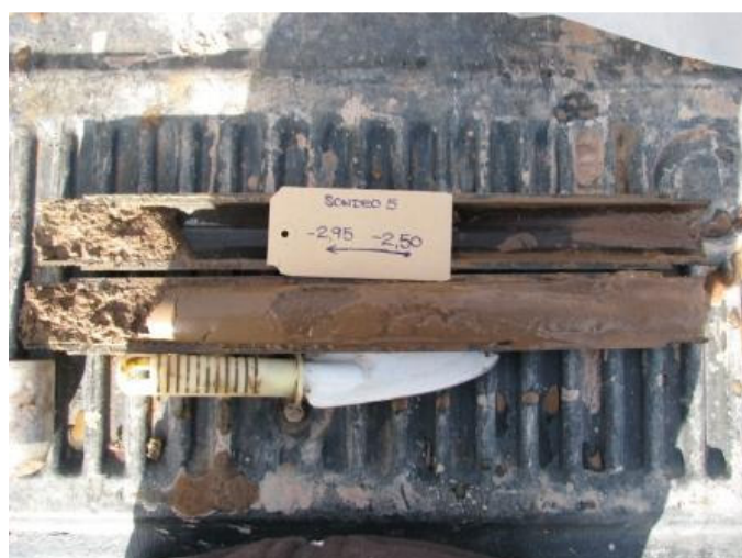
Sondeo N°5 – Muestra 3 – Profundidad -2.50 a -2.95m
