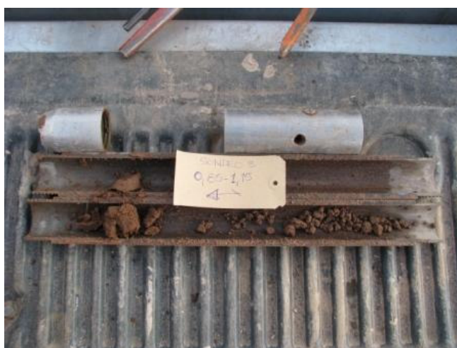
Sondeo N°3 – Muestra 1 – Profundidad -0.55 a -1.15m
