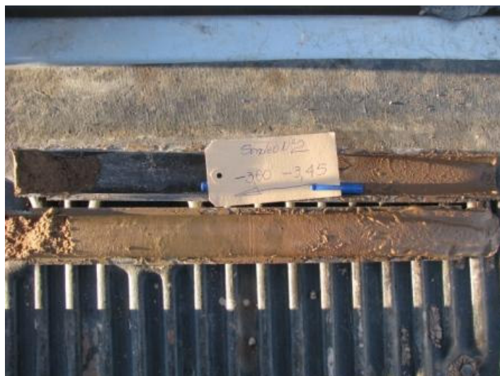
Sondeo N°2 – Muestra 4 – Profundidad -3.00 a -3.45m
