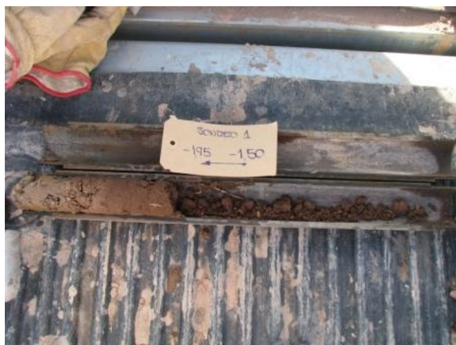
Sondeo N°1 – Muestra 2 – Profundidad -1.50 a -1.95m
