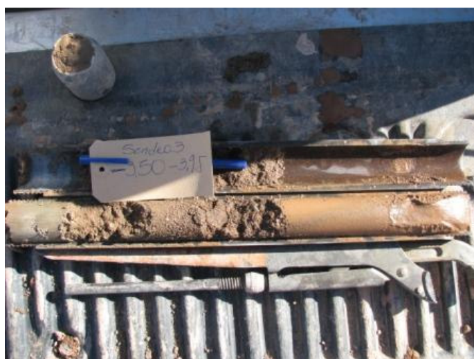
Sondeo N°3 – Muestra 4 – Profundidad -3.50 a -3.95m
