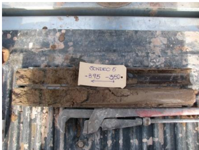
Sondeo N°5 – Muestra 4 – Profundidad -3.50 a -3.95m
