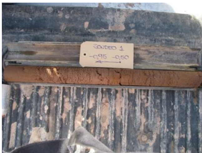
Sondeo N°1 – Muestra 1 – Profundidad -0.50 a -0.95m
