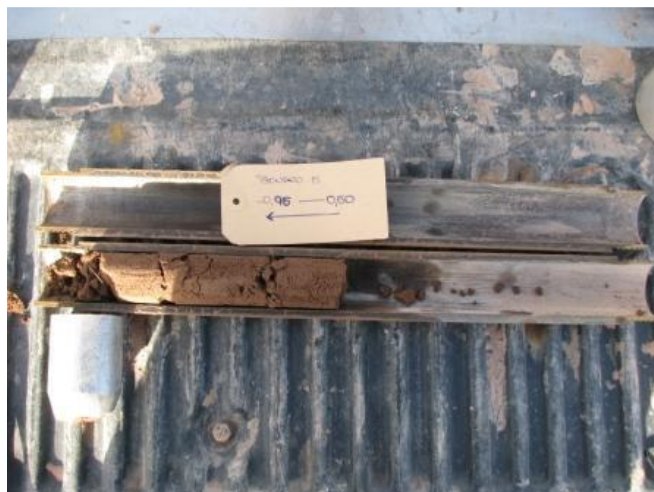
Sondeo N°5 – Muestra 1 – Profundidad -0.50 a -0.95m
