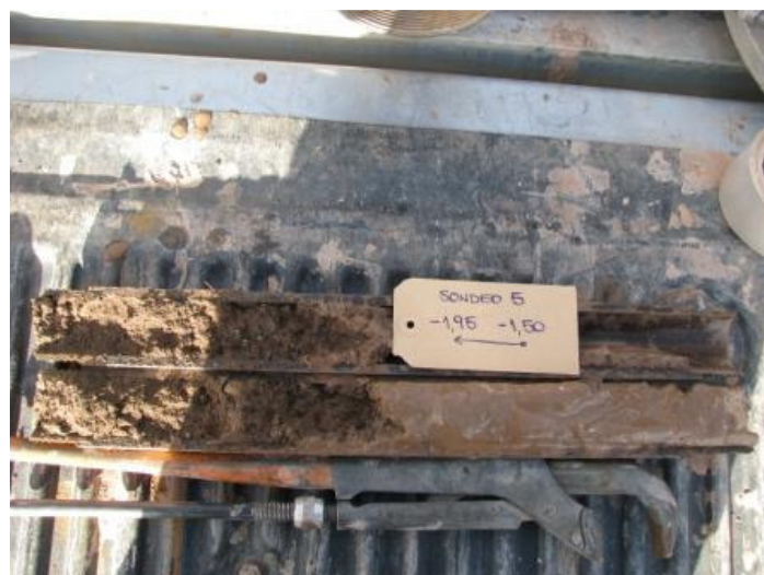
Sondeo N°5 – Muestra 2 – Profundidad -1.50 a -1.95m
