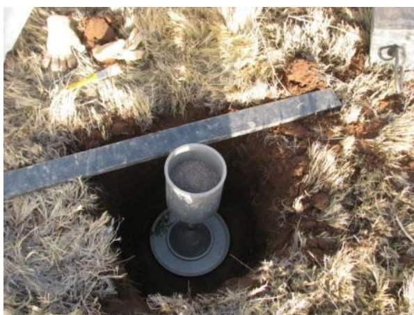
Sondeo N°5-1 – Método del Cono de Arena
