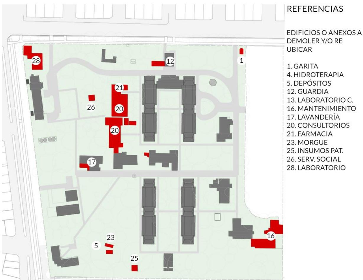
Imagen 5. Diagrama de demoliciones y re ubicación total o parcial de edificios.
