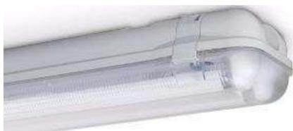
**Tipo F-E:** LUCCIOLA MAREA LEDS – X 501 o equivalente., con dos tubos leds de 28W, de 1260x88 mm con modulo electrónico para transformar el equipo en emergencia (autonomía 2 hs.), con batería de Ni Cd, señalética según especificaciones de SCI, luz fría, completo
