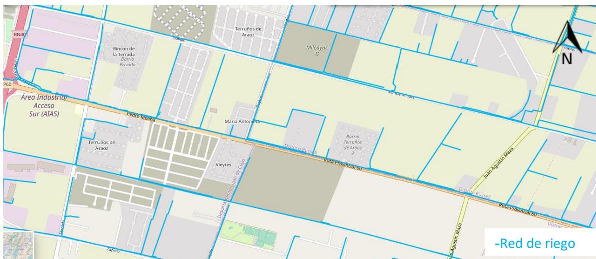
Figura 2. Interferencias del proyecto con la red de riego de la Segunda Zona de Riego. Fuente: elaboración propia - Servidor de mapas DGI.
