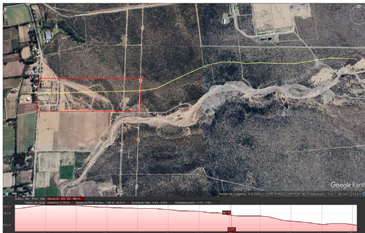
Fig. 1: Ubicación aproximada de la ampliación del predio de la Estación Transformadora (polígono rojo), con su perfil de elevación aproximada.
