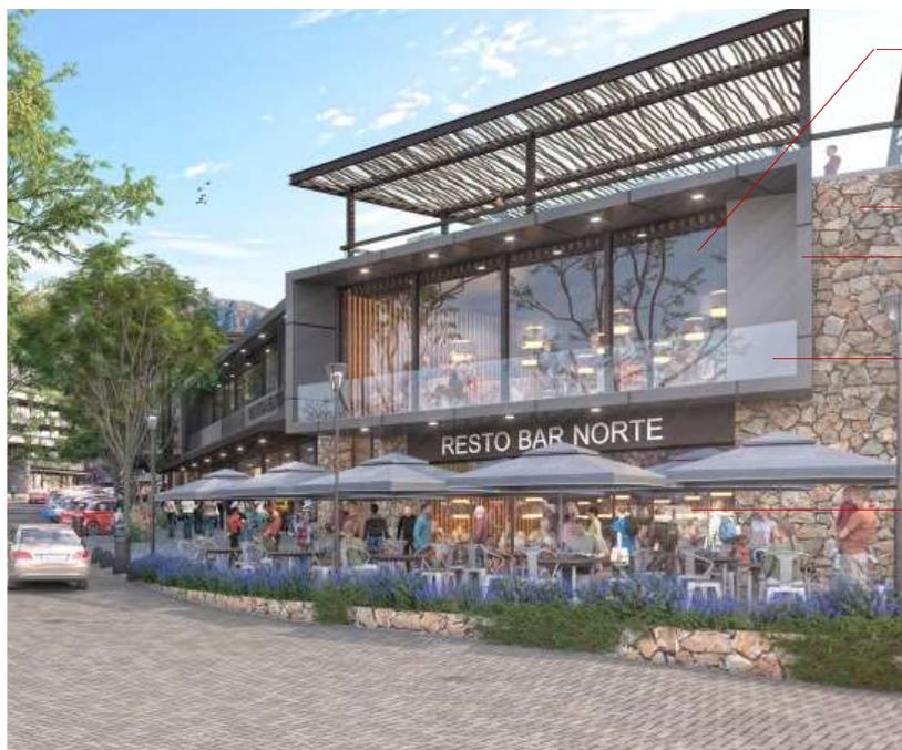
En el caso de Ventanas de abrir "ALUAR A40@ o similar, de terminación anodizado negro con DVH 3+3/12/6 termoendurecido. Subestructura de perfilería de aluminio.
