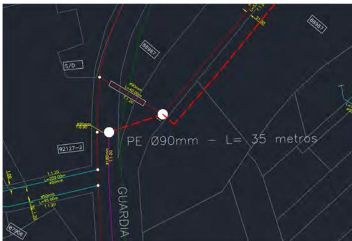
3. Loop en cañería de PE Ø90mm - L=500 metros paralelo a la red existente de PE Ø90mm ubicada en Ruta Panamericana. El loop se conectará a la red de PE Ø90mm y a la red existente de PE Ø125mm (CAO90958) como se indica en la siguiente imagen en línea de trazo color roja.
