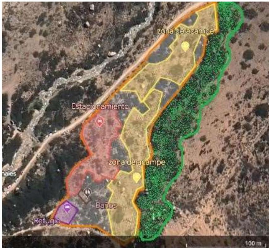
Figura 27: zona de amortiguación en caso de caída de grandes rocas, (en verde) vegetación arbustiva densa que puede funcionar como barrera de protección.
