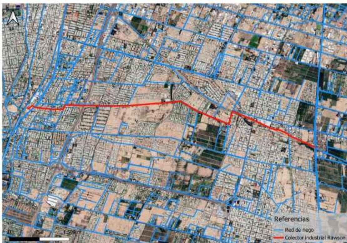
Figura 2. Interferencias del proyecto con la red de riego. Fuente: Área SIG y Teledetección - DGI.
