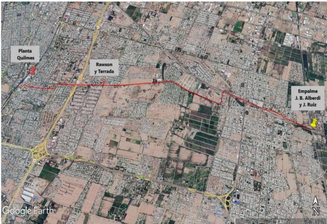
Figura 1. Trazo del Colector industrial Rawson. Fuente MGIA.
